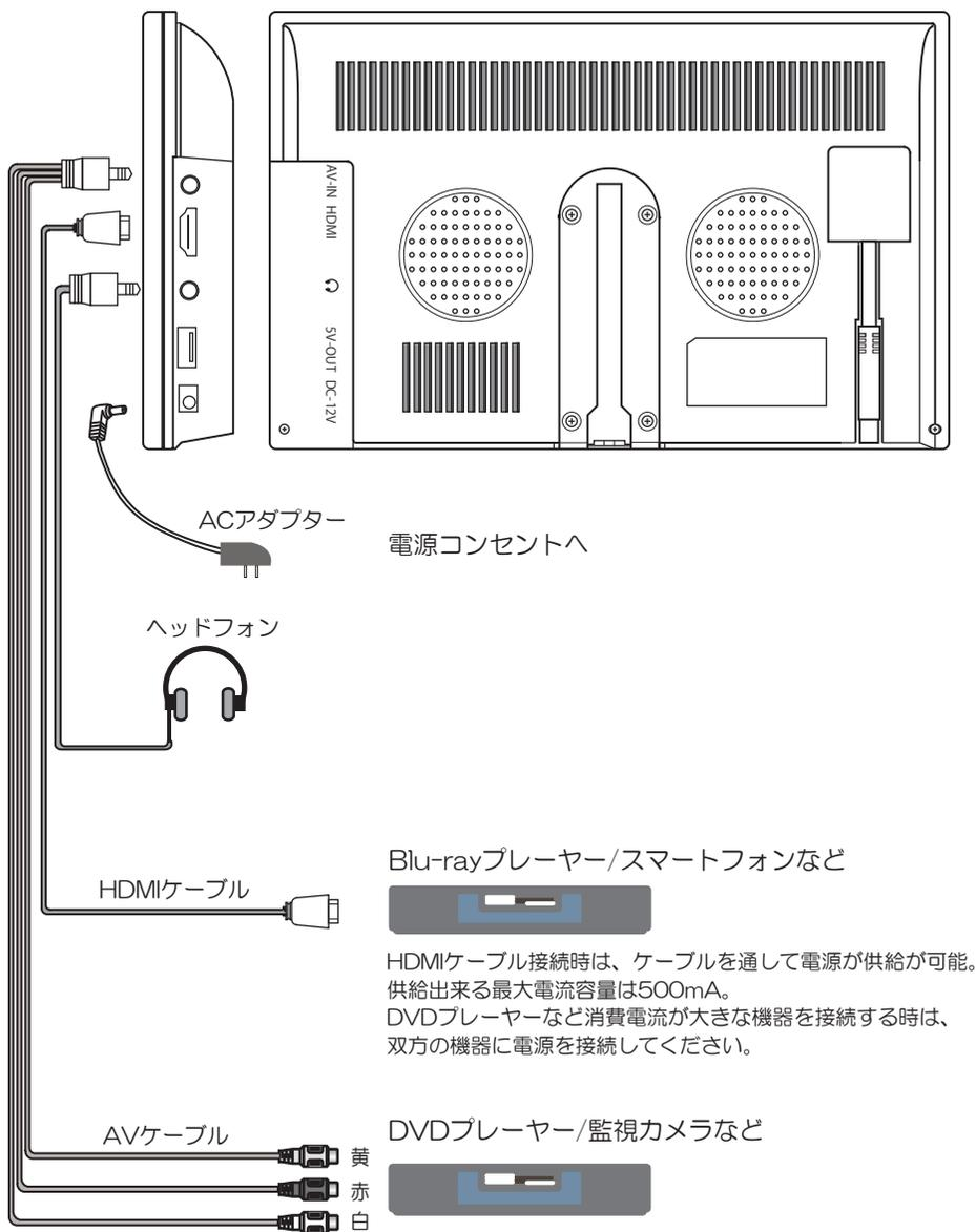
※スマートフォンなど MHL 出力機器を HDMI 変換ケーブルを使用しての接続は、1080p 30Hz を出力する製品には対応していません。接続するスマートフォンによっては、映像が出ない場合があります。また、画像の上端や下端がはみ出て、切れてしまう場合があります。
